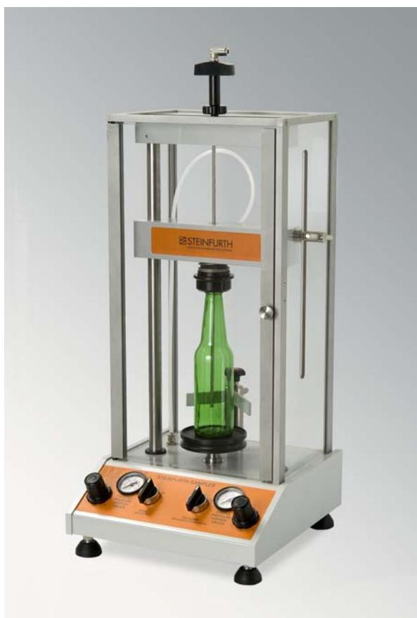
Das Steinfurth Probeentnahmesystem erlaubt die Probeentnahme aus Flaschen und Dosen. Der Anstichvorgang erfolgt pneumatisch und erfordert daher keine großen Handkräfte. Das Steinfurth Probeentnahmesystem ist z.B. für Gasanalysen (Sauerstoff, Kohlendioxid, usw.) und Schaumstabilitätsmessungen geeignet.
